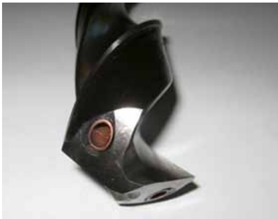
Punta elicoidale con fori di refrigerazione forzata
